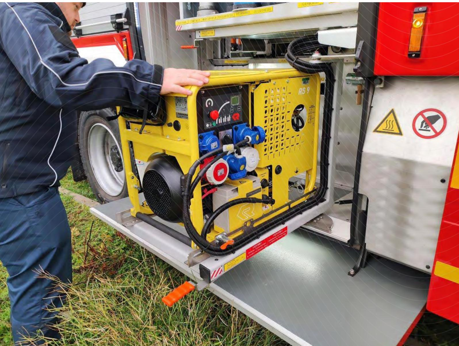
Generator: Das externe Stromaggregat zur Einspeisung der TBS | Bild: AS BB
